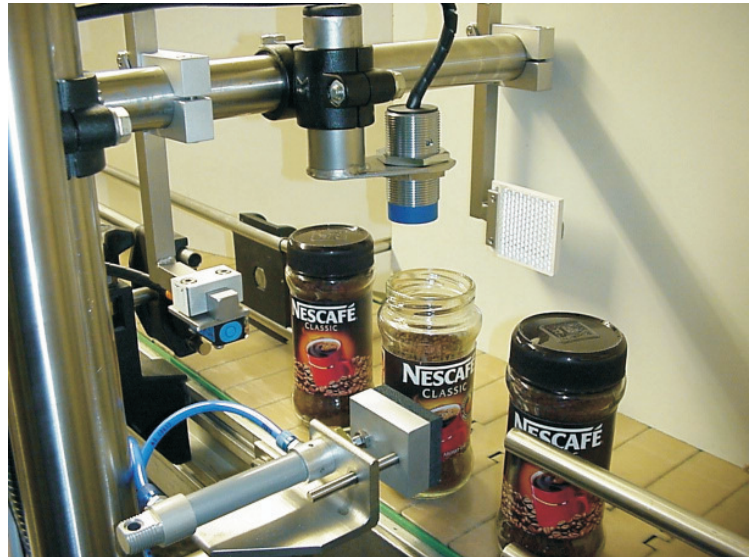
... mit Pneumatik-Pusher Aussortiersystem
