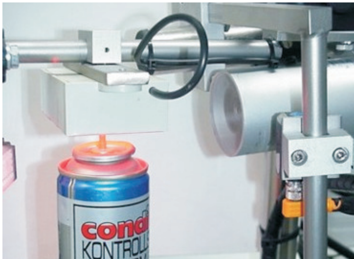
Verschlussvermessung via CCD-Kameratechnik
