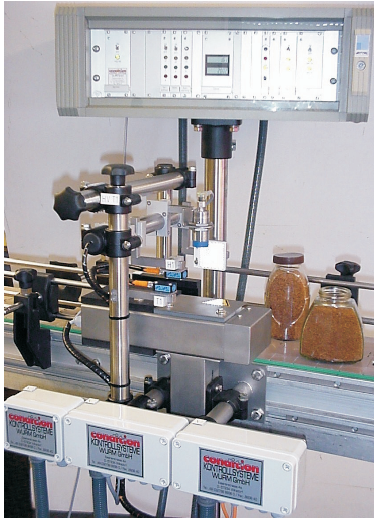
Verschluss- Verschlusshöhen- & Metallfolienkontrolle mit TSS- Aussortiersystem
